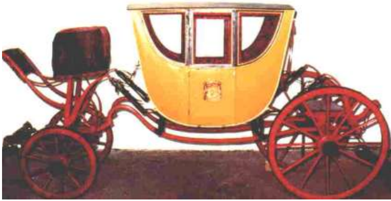
Schweden, um 1790: Reise/Stadtwagen mit Berlinen-Fahrgestell, ähnlich dem Wagen zuvor (Foto: Livrustkammaren, Strömsholm). --- Rechts: Deutschland, um 1790: Reisewagen mit einem Langbaum und C-Federn (Foto: Bentheim-Tecklenburg).
