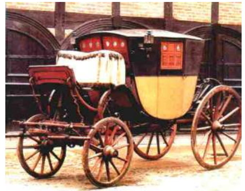
Schweden, um 1790: Reise/Stadtwagen mit Berlinen-Fahrgestell, ähnlich dem Wagen zuvor (Foto: Livrustkammaren, Strömsholm). --- Rechts: Deutschland, um 1790: Reisewagen mit einem Langbaum und C-Federn (Foto: Bentheim-Tecklenburg).
